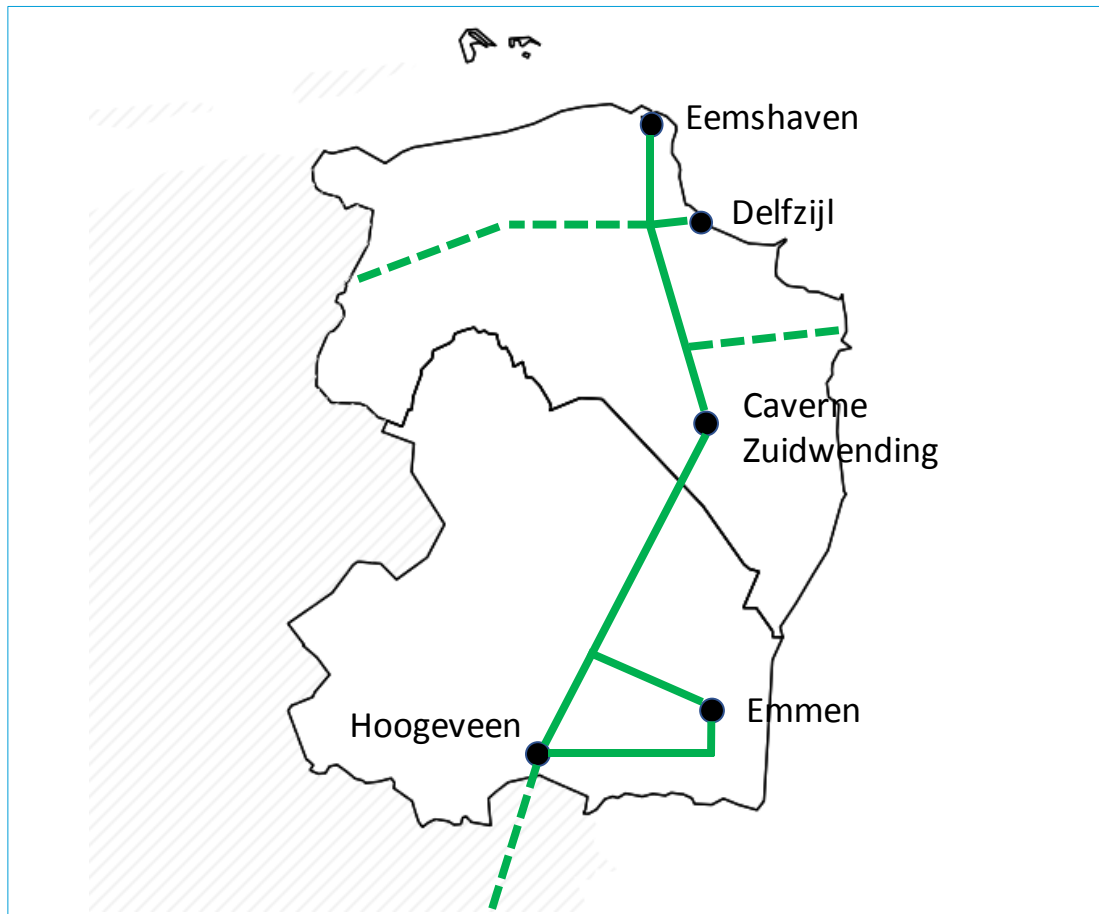
Figuur 41 - Noordelijke waterstofbackbone te realiseren uit vrijvallende infrastructuur vanaf 2023 (stippelijnen zijn opties voor aansluiting op de landelijke waterstofbackbone in 2030)
